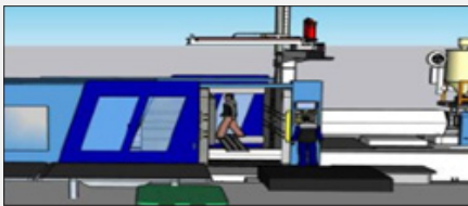
재해자가 사출성형기 내부에 대기한 상태
